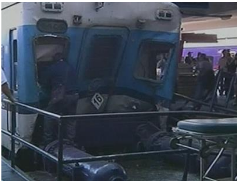
Figur 5. Tågets front trycktes in nästa en meter. Stoppcylinderna hade låsts i fast läge på 1970-talet. Foto: Reuters
