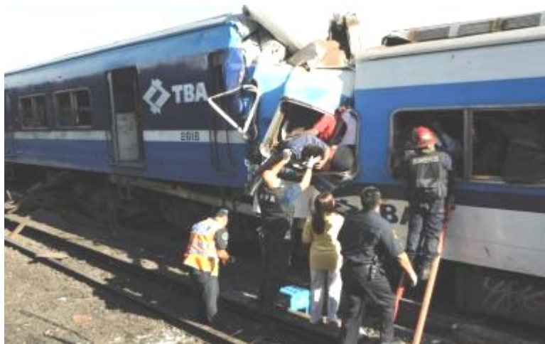
Figur 7. Vagn nummer två som pressats 6 meter in i första vagnen. Foto: Martín Qvintana, EPA
