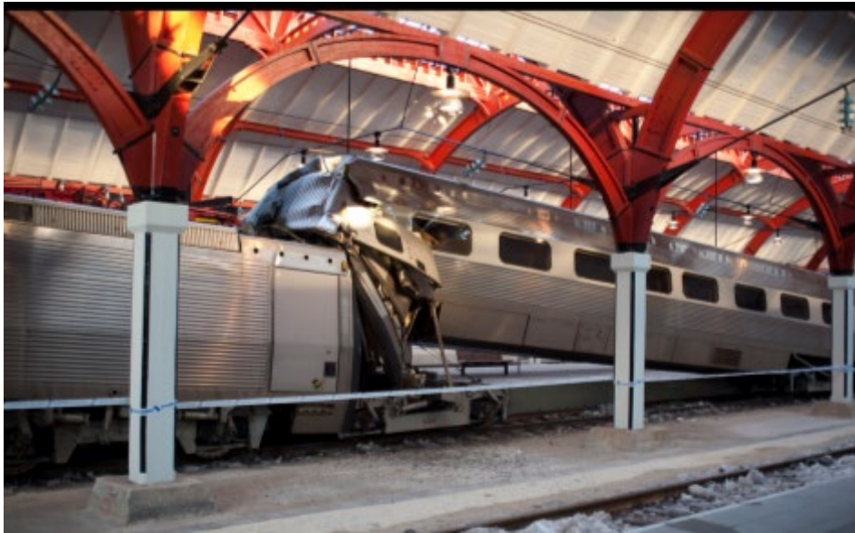
Figur 2. Ett tomt X2000-tåg som i låg hastighet kört in i stoppblocken på Malmö centralstation 2011. Notera deformationen hos dessa vagnar, som är bland de modernaste snabbtågsvagnar vi har i Sverige. Foto: http://onetub932.blogspot.se/2011/01/centralstationen-malmo.html
