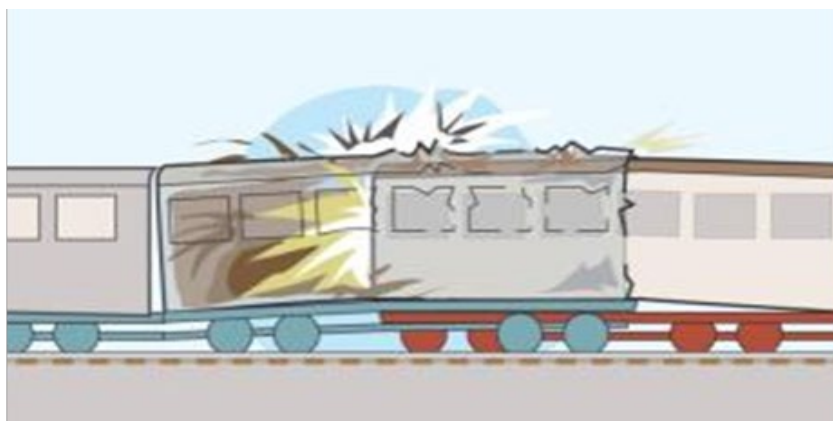
Figur 6. Schematisk bild av hur vagnarna trycks in i varandra som ett teleskop - en kraschmekanism som var vanlig i tågtrafik före 1950-talet och som man strävat efter att bygga bort genom starkare koppel och införandet av deformationszoner. Bild från Forsberg [12]
