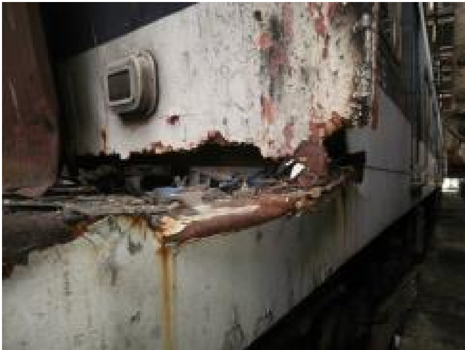
Figur 14. Omfattande rostangrepp på en av de kraschade vagnarna – kanske en indikation på bristande underhåll. Sannolikt skulle strukturernas hållfasthet ha varit bättre om sådana defekter inte förelegat. Foto: Ulf Björnstig
