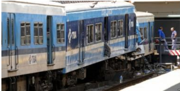
Figur 7. Vagn nummer två som pressats 6 meter in i första vagnen. Foto: Martín Qvintana, EPA
