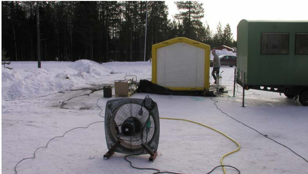
Figur 7. Skapande av kontrollerad vind med hjälp av fläkt.
