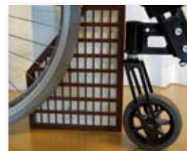
En tidskriftssamlare tjänar som vinkelhake vid lodning av länkhjulen.
